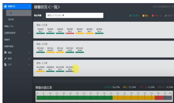
工場稼働管理IoTシステム (センサーモニタリングシステム)
