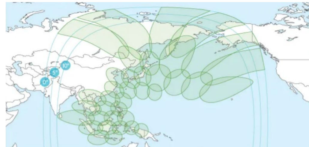
JCSAT-1C が搭載する Ku 帯スポットビームのカバーエリア
