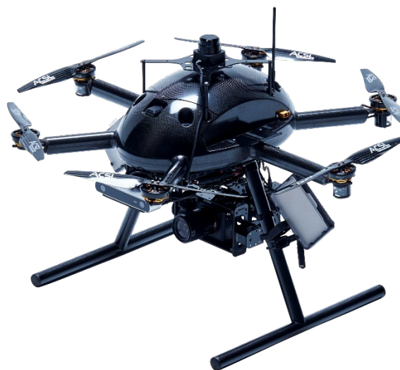
煙突点検用ドローン
