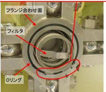
ボルトを締付工具により確認したところ、締付力が規定値よりも不足していた
