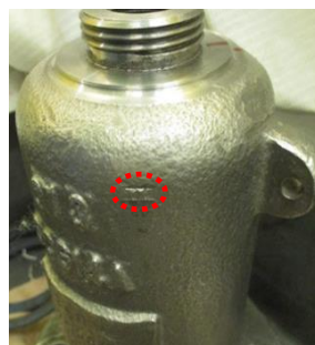
打痕を確認 (長さ9mm、幅1mm)
