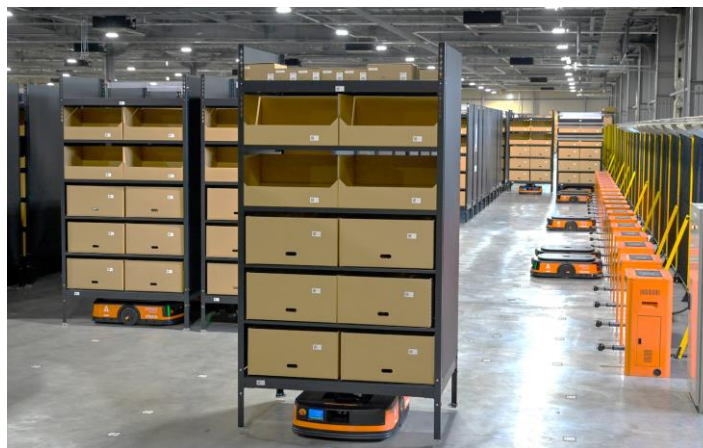
AGV（自動搬送ロボット）が稼働するGTPエリア
