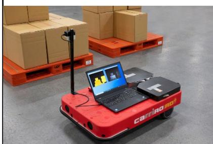
距離計測するTOF（Time Of Flight）カメラを使用します。計測されたパレット上の荷物の距離情報を基に、荷物の在庫状況（個数）を自動で確認するシステムです。
