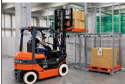
「アクティブRFIDタグ」を搭載したパレットと「リピータ（中継機）」、「リーダー（受信機）」を使用し、どのラックにどのパレットがあるかを自動で管理します。パレットに製品情報を紐づけておくことにより、ラック上の在庫情報もリアルタイムに確認可能です。
