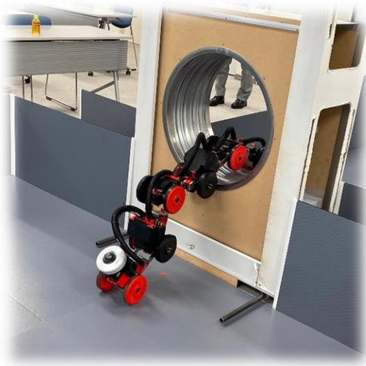
建物の地下ピット内の点検員による目視点検が不要となるので、**点検員の業務環境を改善**することができます。また、ロボットは自律的に動作をするため、遠隔操作が不要となり、**業務の効率化**を図ることが期待されます。2023年4月より弊社作業所にて実運用開始予定、2025年頃には一般販売を目指しております。
