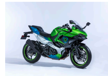
ハイブリッドモーターサイクル のプロトタイプ (2024年に上市予定)
