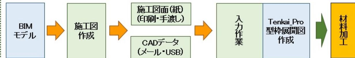
BIMコンバーターを利用した業務フロー
