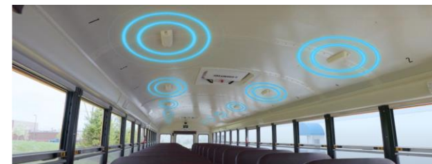
IEE社：子ども置き去り検知センサー (LiDAS™)
