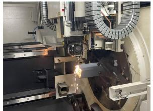
長尺パイプ・形鋼を、様々な角度、形状にレーザー切断、タップ加工できる加工機です。素材の搬入から加工・切断部材の搬出まで、自動で行うことができます。筐体フレームや建築構造物部材の加工に用いることのできる設備です。
