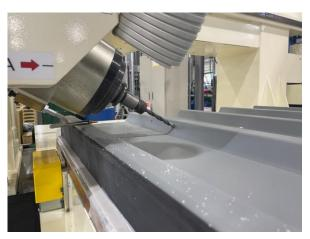
橋梁土木工事用の建材の一部として用いる金属サンドイッチパネル製造用の加工機として用いております。高速道路や鉄道高架などの橋梁における保守点検作業を効率化できるほか、防錆、美装などの用途も付加できるため、今後普及が期待される建材です。
