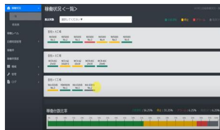
工場稼働管理IoTシステム (センサーモニタリングシステム)
