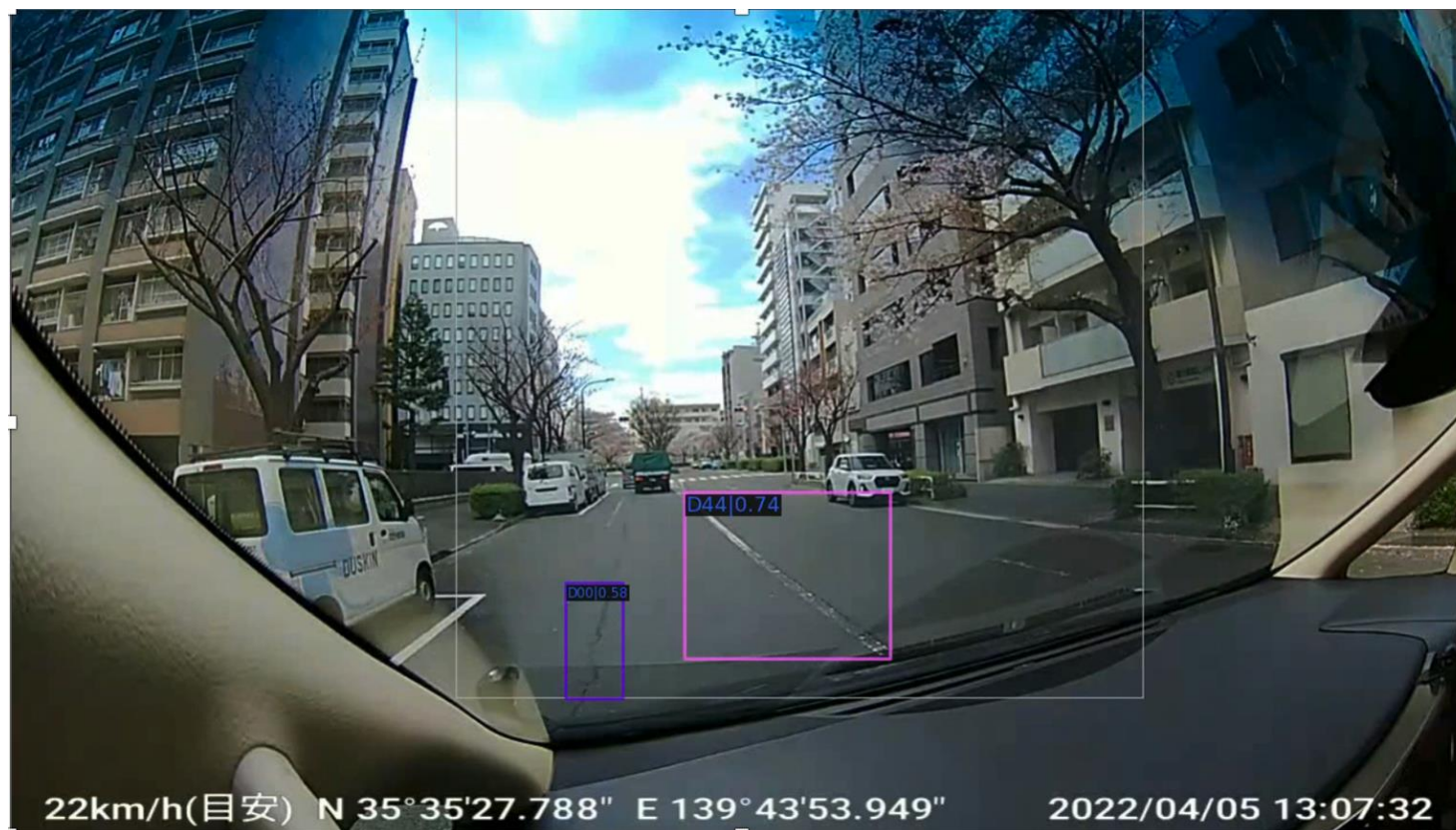
ミックウェアに納品した、道路のひび割れ、白線のカスレを自動検知するソフトウェア
