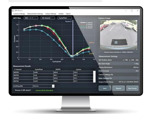
魚眼レンズを備えた車載カメラの 解像度測定に最適
