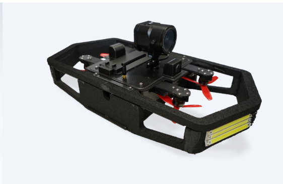
Fi4 (閉鎖環境点検)
