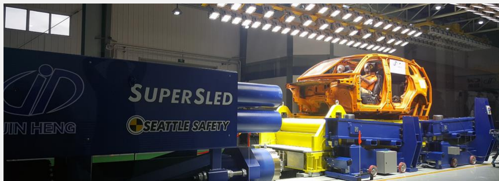
加速式スレッド試験機： 主に自動車関係の衝突安全試験に使用されています。
