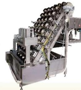
従来手作業で行っていた調理麺製造におけるソースなどの調味液等添加・攪拌工程を無人化することで、雑菌及び異物混入のリスクを低減し鮮度延長によるフードロス削減、省人化によるコスト削減、高度な清掃性実現したことが評価された
