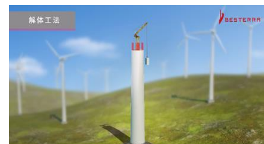
タワークレーン工法
