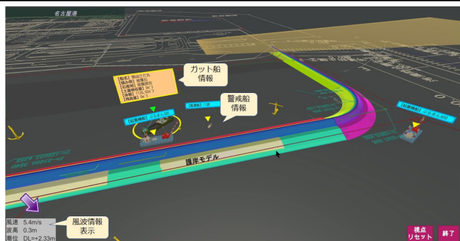
海上工事デジタルツイン
