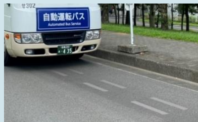
2022年9月には新たに自動運転用塗料「ターゲットラインペイント」を使用開始
