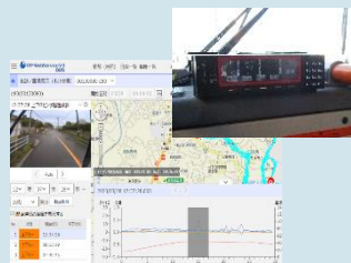
路線バスへ導入を開始した通信型ドライブレコーダ・ドライブレコーダと、本装置から発信された危険挙動通知画面
