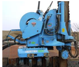
サイレントパイラー工法
