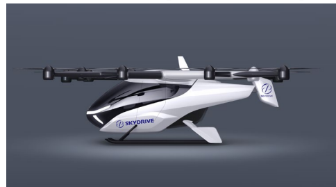
SkyDriveが設計開発中の「空飛ぶクルマ」の商用機「SD-05」
