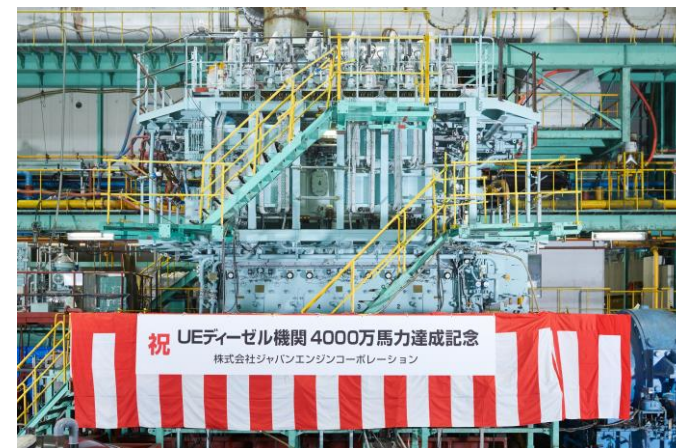
6UEC42LSH-Eco-D3-EGR型機関 (2022年/4,000万馬力達成エンジン)
