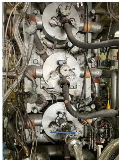
アンモニア・石炭バーナ混焼試験
