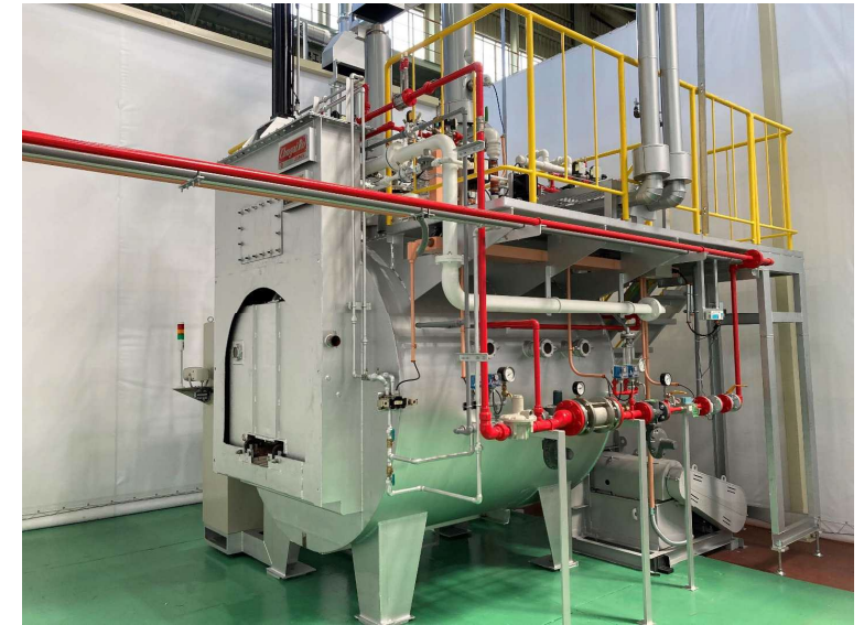
2022年4月に堺事業所に設置したラジアントチューブ型水素燃焼実証炉
