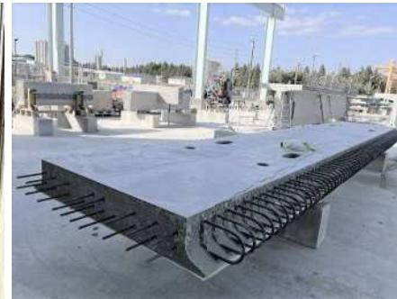
蒸気養生不要とするコンクリートで製造したPCaPC床版
