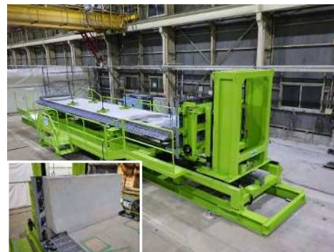
プレキャスト壁高欄製造装置 当社独自技術「フルキャスト壁高欄」を効率的に製造する装置
