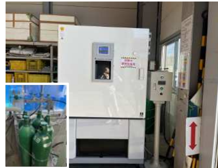
カーボンネガティブコンクリートの開発（炭酸化養生装置）
