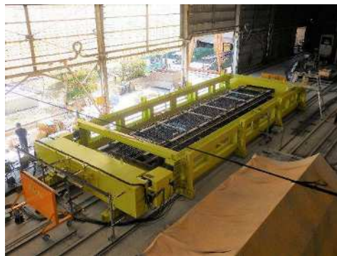
PCaPC床版製造・緊張装置 製造場所を限定しない独立して緊張が可能な装置
