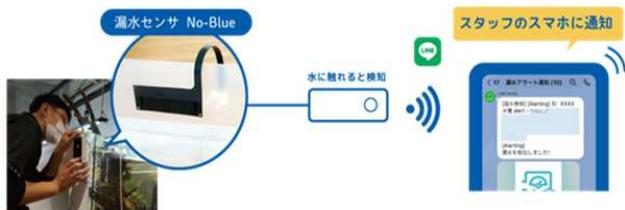
共同研究では、帝国通信工業がフィルム式の静電容量式センサを水族館向けに改良した「No-Blue (ノーブルー)」を開発。センサまで水位が達すると、飼育スタッフのスマートフォンのメッセージアプリ「LINE」に通知が届く仕組み、および検知データを可視化する仕組みの構築をKDLが担当しました。また、átoaの「展示水槽」や「ろ過槽(※)」などに「No-Blue」を取り付け、テスト・評価をátoaの飼育スタッフが担当しました。
