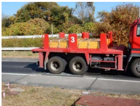
舗装走行実験場での荷重車走行状況
