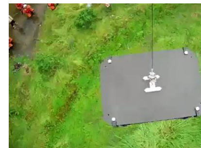
電動ウィンチシステムを用い、着陸することなくコンテナを地面におろす コンテナが地面に着いたら自然と開く、自動開放フックを採用
