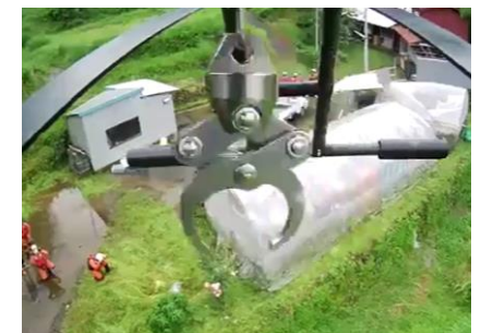
電動ウィンチシステムを用い、着陸することなくコンテナを地面におろす コンテナが地面に着いたら自然と開く、自動開放フックを採用
