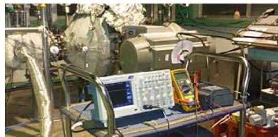
各種実験プラントを自社で所有してバルブ特性や流量特性などの実験を行い、データを収集・解析。耐熱温度範囲は「-196℃～700℃」となり、顧客ニーズにより近い環境を実現可能にしている。
