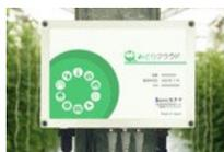
IoTデバイスによって圃場の環境を計測し、クラウドへ蓄積。圃場環境の異常検知・通知を行う。
