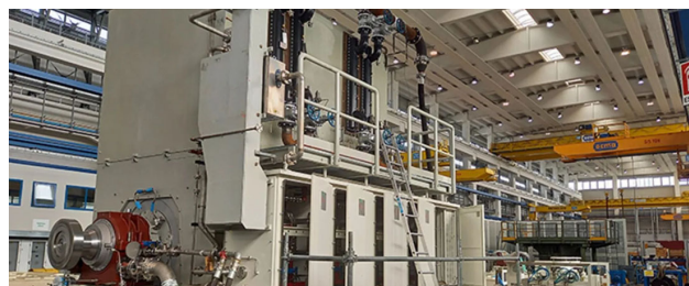
ニデック・コンバージョン事業の出力45メガワット高スピードモータ
