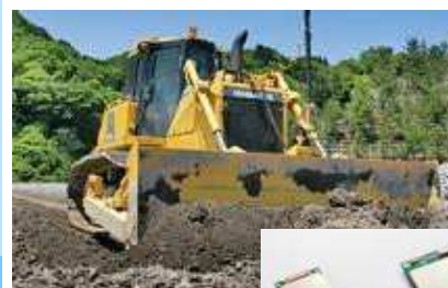
GNSSシステムブルドーザ
