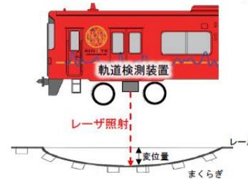
レールにレーザを照射すること等で、線路のゆがみを測定
