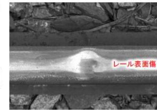
ラインセンサカメラにて、レール表面の傷や各種部材を高精度に撮影
