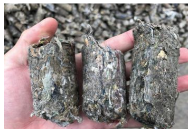
リサイクル燃料 産業廃棄物を原料に固形化したRPF※を高品位燃料として国内メーカーのボイラー向けに供給しています。
