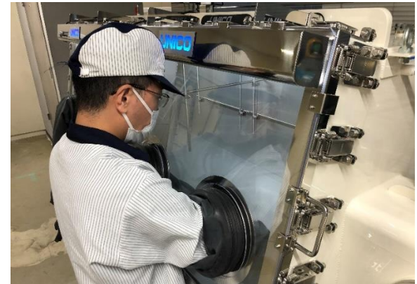
セル解体用グローブボックス
