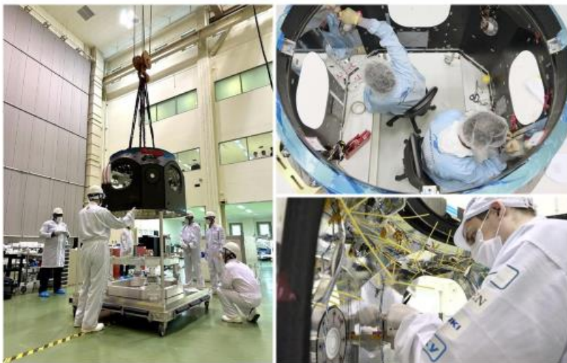
左図: JAXA 探査施設にてランダー(月面探査)のモックアップの組立作業をしている様子 右図(上): ドイツの施設にてモックアップの内部に試験用のためのケーブルを接続している様子 右図(下): JAXA 探査施設にてモックアップの内部に試験用のためのケーブルを接続している様子
