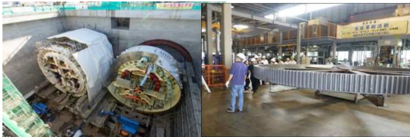
トンネルマシン用歯車付旋回ベアリング(外径 約8.0m)
