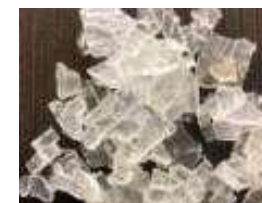
割れパネルのガラス
