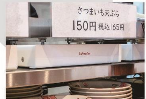
物の重さを自動的に測り 何を選択したか瞬時に把握 重量センサー
