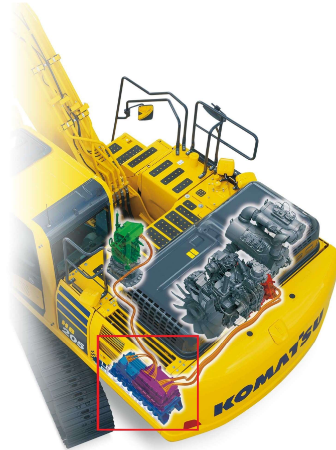
(左) ハイブリッド油圧ショベル稼働写真、(右) コマツハイブリッドシステムのイメージ
