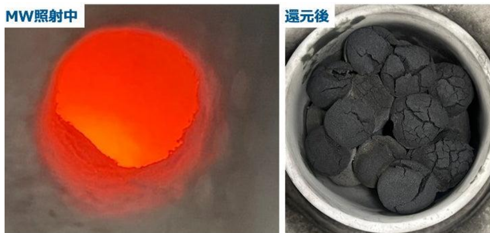
ラボでのマイクロ波による鉄鉱石の還元
