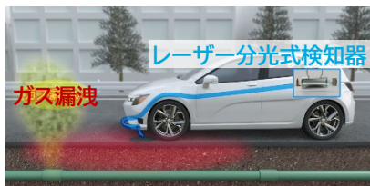
自動車式検知器による漏洩調査
