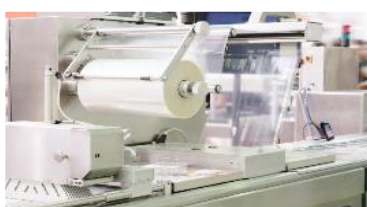
フィルムコーティング層の剥離装置
