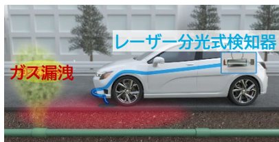
自動車式検知器による漏洩調査
