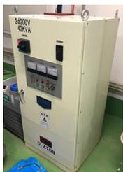
過熱水蒸気発生装置
