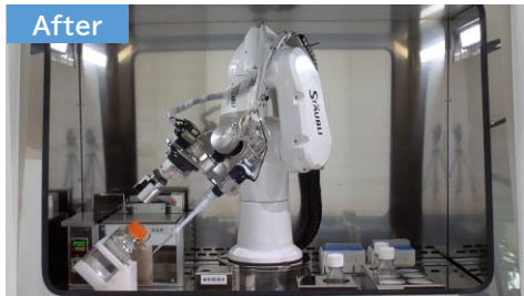
アイソレータ庫内にロボットを組み込み 高浄度環境下でのラボ作業を自動化
