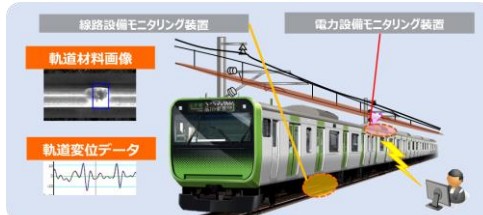
CBM（地上設備モニタリング）
