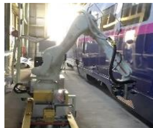
側ふさぎ板自動取り外し装置
