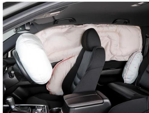
1986年にエアバッグの開発に着手し、1989年に量産を開始。座席サイド部分に内蔵される「サイドエアバッグ」や「カーテンエアバッグ」等、正面衝突以外の衝撃を緩和するための多種多様なエアバッグを製造しています。
